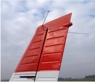
VOR-antenne op het kielvlak van een Piper Warrior.
