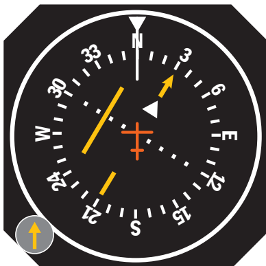
Figuur 1-1. Voorbeeld van een HSI. De gele naald en witte driehoek zijn onderdeel van de VOR-aanwijzer.
